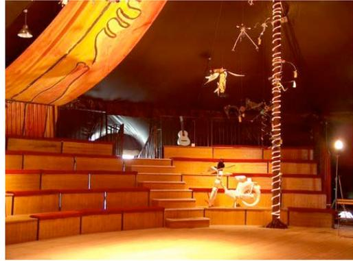
Chapiteau homologué sous le N° 01-41. De forme elliptique, entourages en abside. Dimension 12,5 m / 18,5 m aux poteaux de tour, et 17,5 m / 23,5 m aux pincés, surface couverte 330 m<sup>2</sup>.
